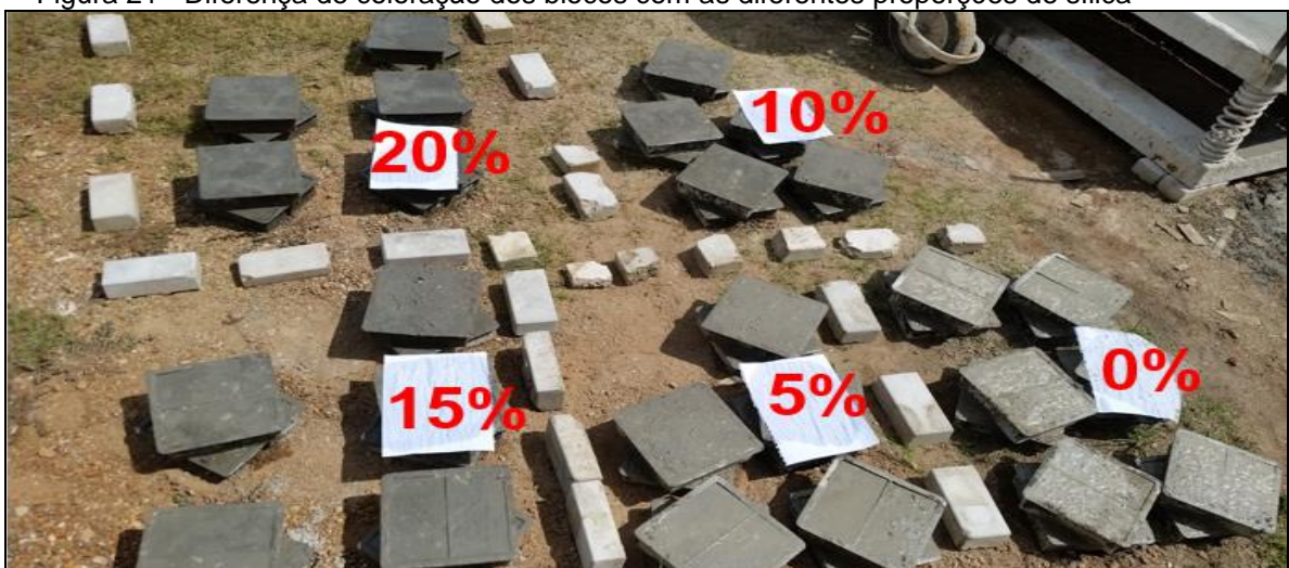
Figura 21 - Diferença de coloração dos blocos com as diferentes proporções de sílica
