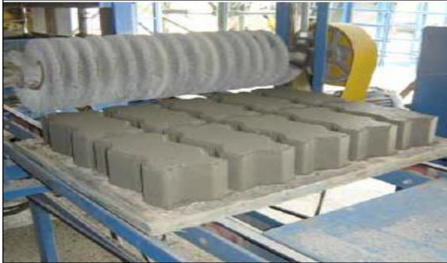
Figura 11 - Fabricação de blocos de concreto intertravado com vibroprensas
